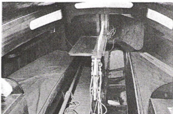
Assez claire, la cabine est encombrée par le puits de dérive, celle-ci coupant d'ailleurs la table en deux lorsqu'elle est en position relevée. On aperçoit de part et d'autre du puits, les six drisses qui parviennent jusqu'à ce véritable centre nerveux du bâtiment.
