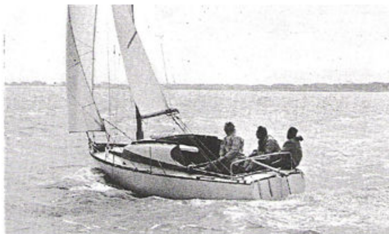
Tiré par son génôis, le DC 20 soutient au large des vitesses assez élevées. La ferrure qu'on aperçoit sur le tableau sert au montage de la chaise du moteur hors-bord auxiliaire.
