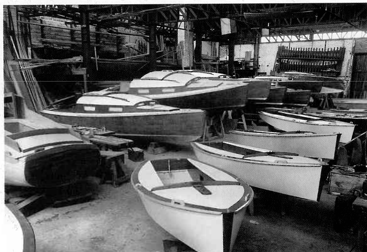
Productions en série. Juste avant de passer au polyester, Bélouga et Mousse étaient mis en chantier par ensembles de douze à vingt-quatre à la fois.
