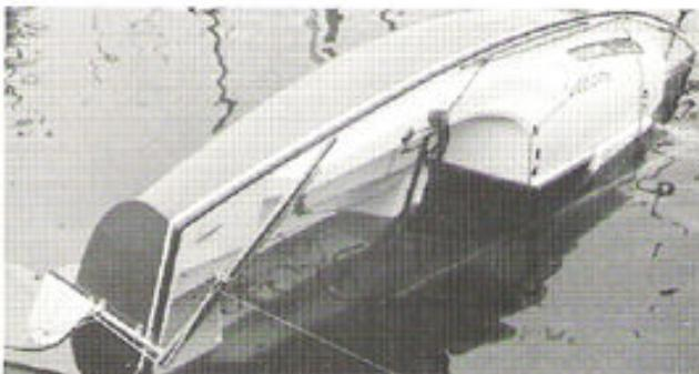
Um die Schwimmfähigkeit abklären zu können, musste die Kabine mit Wasser gefüllt werden.
